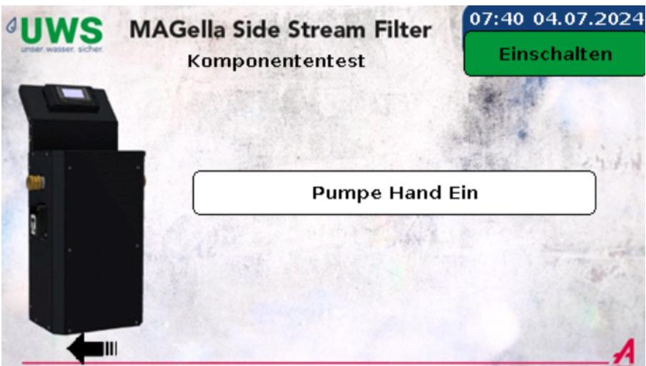
Auf der Seite „Komponententest“ kann die Pumpe manuell ein- und wieder ausgeschaltet werden.
