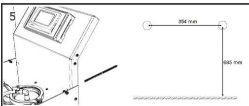
Alternativ kann das Gerät über 2x M8-Stockschrauben an der Wand befestigt werden.
