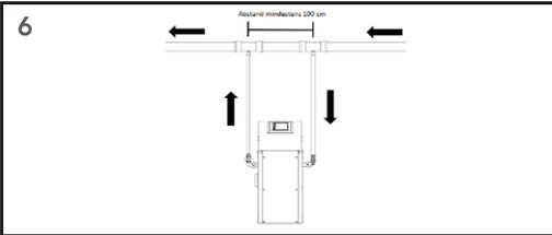
Gerät laut Bedienungsanleitung an den Rücklauf der Anlage anschließen.
