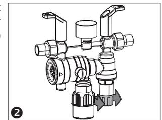
Drehen Sie nun den Einstellgriff in Richtung Plus (+), um den Fülldruck zu erhöhen.
