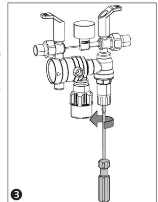
Ziehen Sie nach Erreichen des gewünschten Druckwertes die Sicherungsschraube wieder an. Nun können Sie das Ausgangsventil (2) öffnen.
