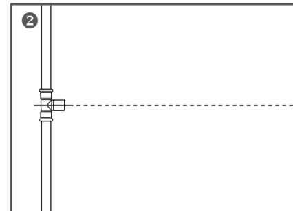
**2** Übertragen Sie die Mitte des Anschlusses an die Wand
