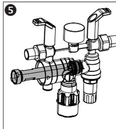
❻ Achten Sie darauf, dass die Aussparungen der Montagehilfe in die Zapfen des Rückflussverhinderers greifen.
