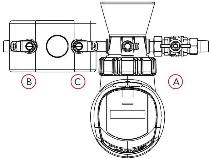
Schließen Sie nach Beendigung des automatischen Befüllvorgangs alle Absperrungen (A-C), um eine unkontrollierte Nachbefüllung zu vermeiden.
