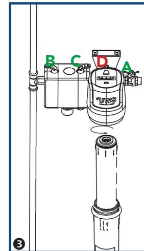
3 Schließen Sie den Kartuschenbehälter mit dem Schlüssel gegen den Uhrzeigersinn.
