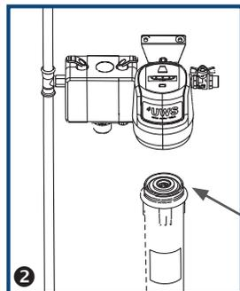
2 Entnehmen Sie die verbrauchte Kartusche und entsorgen diese. Die Kartusche ist kein Sondermüll und kann daher im Hausmüll entsorgt werden.
