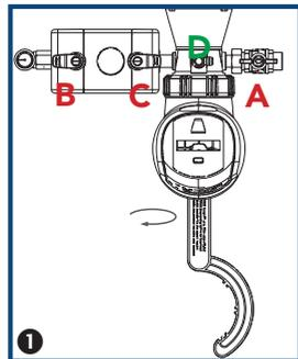
1 Schließen Sie den Zulauf (A, B und C) und öffnen Sie die Entlüftung (D).
