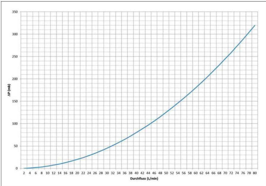
Bild 9-11: Kennlinie Magnetflussfilter
