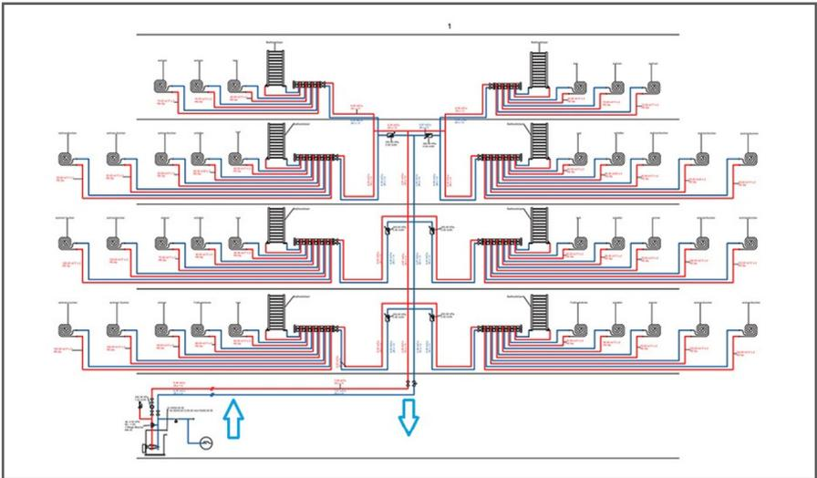
Bild 4-8: Anschlusschema Bypass-Verfahren
