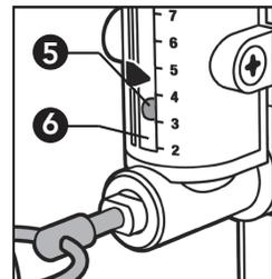
4. Nach der Einregulierung den Ring (2) des Schiebers des Durchflussmessers wieder loslassen; eine eingebaute Feder b wirkt, dass er automatisch wieder in die Schließposition zurückkehrt.
