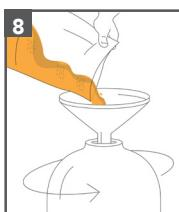
8. Open de navulverpakking met mengbedhars en vul deze met behulp van een trechter in de cilinder. Verdicht indien nodig het mengbedhars door de composietcontainer/ cilinder te schudden of te draaien.
