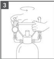
3. Drehen Sie den 3-Wege-Kopf am Griff entgegen des Uhrzeigersinns, um den 3-Wege-Kopf zu lösen.
