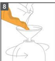
8. Öffnen Sie das Nachfüllpack mit Mischbettharz und füllen Sie es mithilfe eines Trichters in den Composite-Behälter ein. Verdichten Sie das Mischbettharz hierbei bei Bedarf durch Rütteln oder Kreisen des Composite-Behälters.
